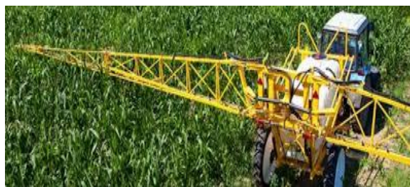
Рисунок 4.10 - Опрыскиватель штанговый ОПШ-24-300 ( а ) Применение опрыскивателя штангового ОПШ-24-300 ( б )
