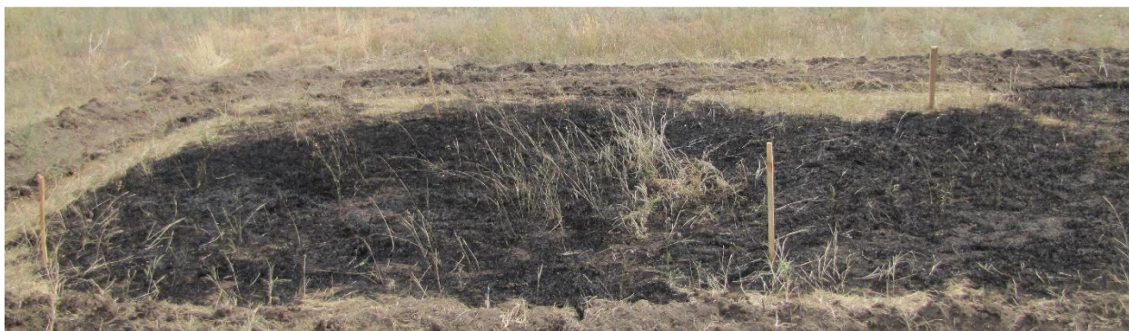
Рисунок 4.8 - Результаты исследования огнепреграждающих свойств секторов, обработанных водными растворами бурь с концентрацией 14-56 г/дм 3
