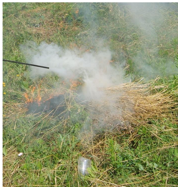
Рисунок 4.12 - Применение парогенераторной установки для экспериментального тушения низового пожара
