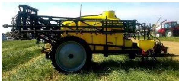
Рисунок 4.10 - Опрыскиватель штанговый ОПШ-24-300 ( а ) Применение опрыскивателя штангового ОПШ-24-300 ( б )
