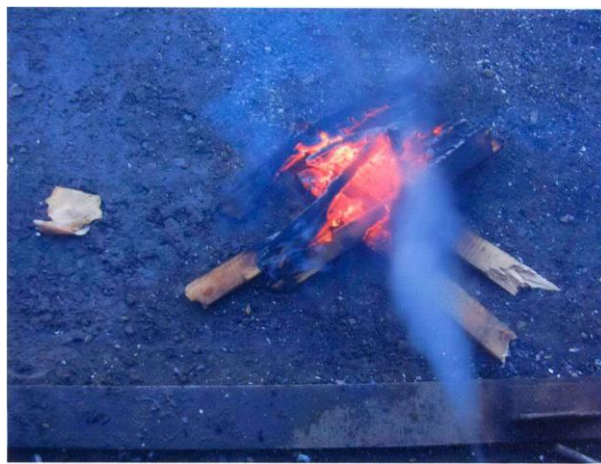
Рисунок 4.14 - Воздействие струи водяного пара на горящие бруски древесины
